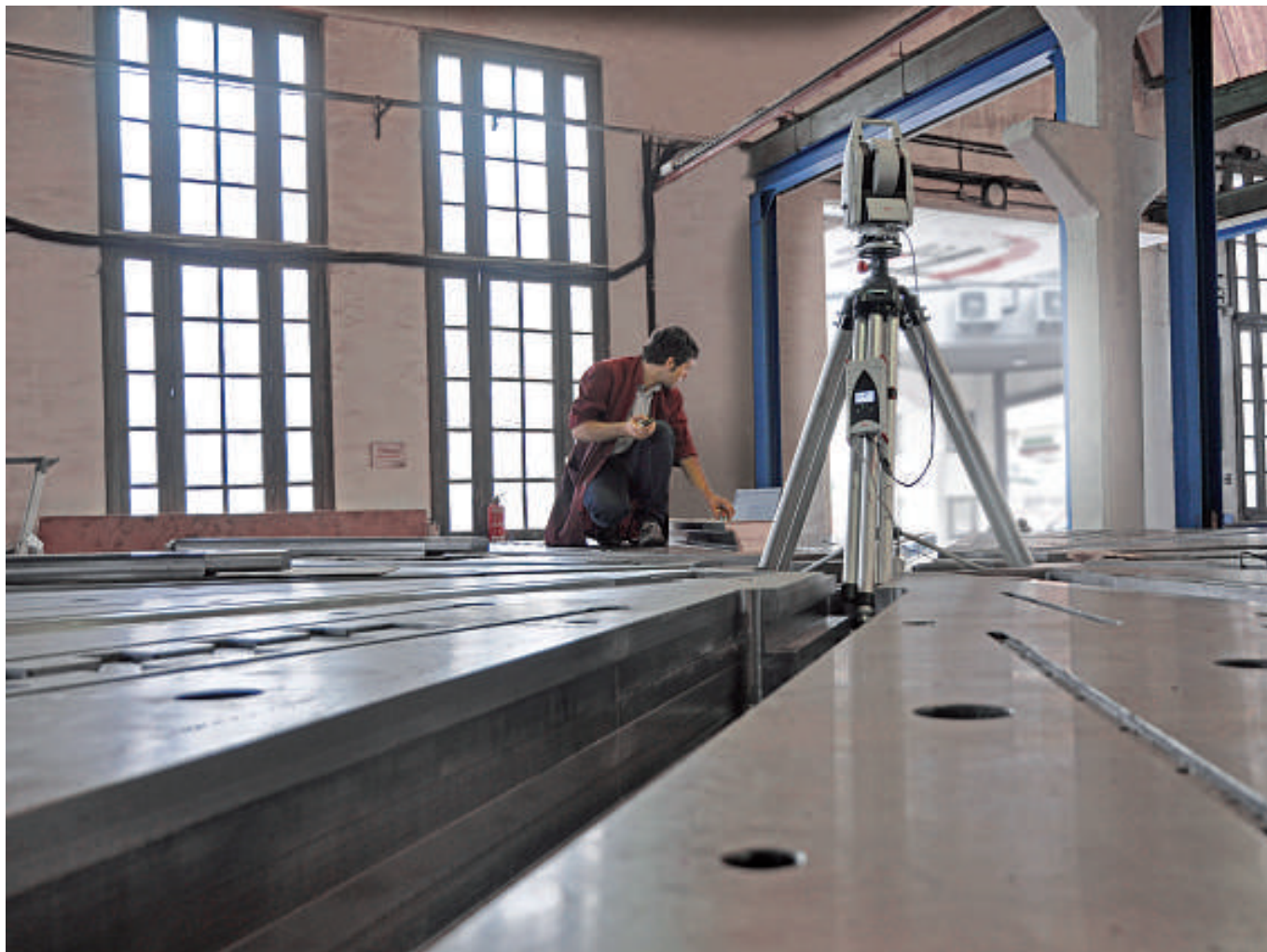
L'autre évolution a été l'apparition du laser tracker pour mesurer avec précision les grands éléments en un temps record.
