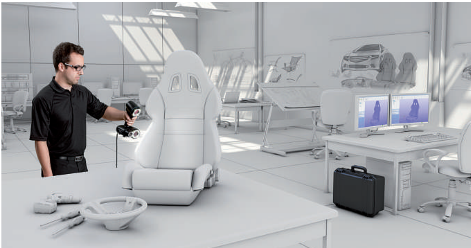
Le Go! Scan 3D est utilisable dans un environnement quelconque afin de relever des nuages de points dans l'espace sans contact avec la pièce. Il rend la numérisation 3D encore plus facile pour des mesures rapides et fiables.
